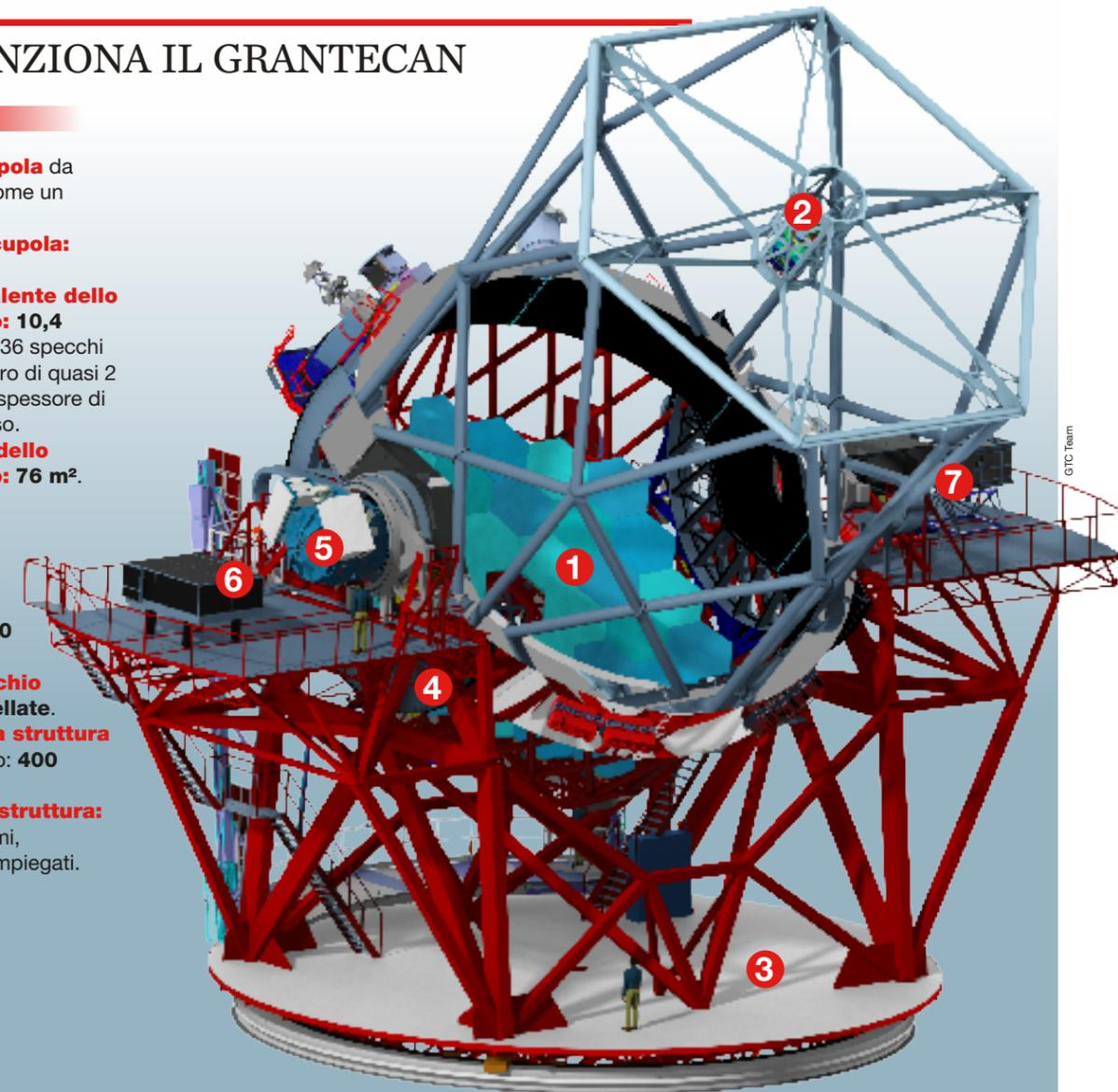
**IL GRANTECAN** è controllato da 3 server cablati in rete, che gestiscono in tempo reale i movimenti della struttura calcolando la posizione delle stelle 20 volte al secondo per mantenere il telescopio perfettamente puntato sull'area di cielo da studiare. Il telescopio ha una montatura azimutale, cioè si sposta sia in verticale, sia ruotando su se stesso: permette di osservare qualsiasi zona del cielo al di sopra dei 16 gradi di elevazione rispetto all'orizzonte.
